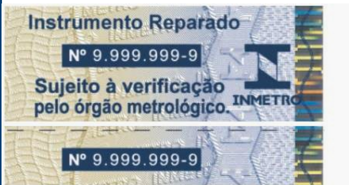
Acima: Marca de reparo
