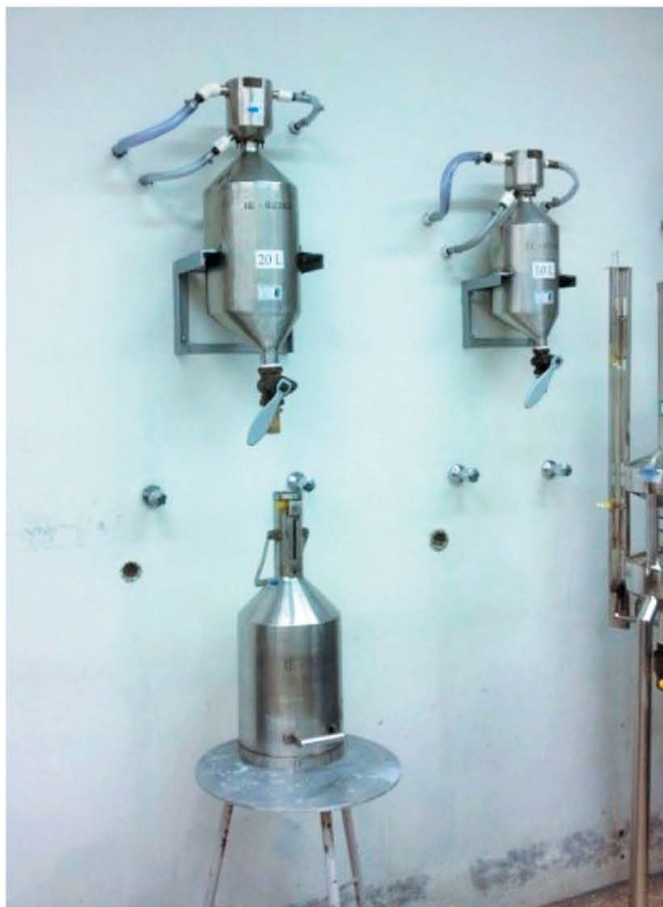
Medida de volume (sobre a mesa) utilizada para fiscalizar postos de gasolina é calibrada por comparação com medida padrão de volume no Laboratório de Volume do DMCI
