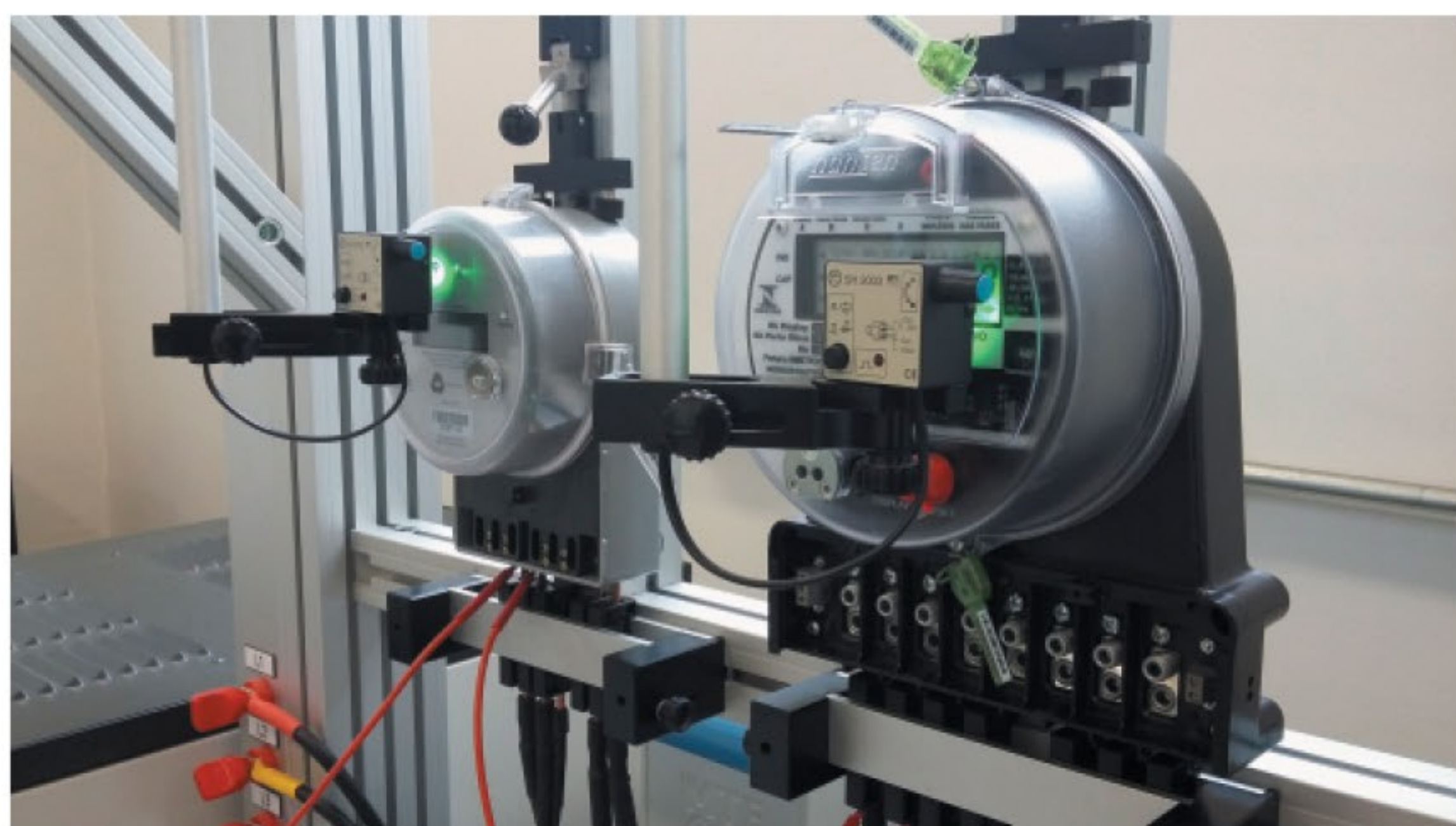
Medidores de energia elétrica são ensaiados em bancada energizada no Laboratório de Elétrica do DMCI
